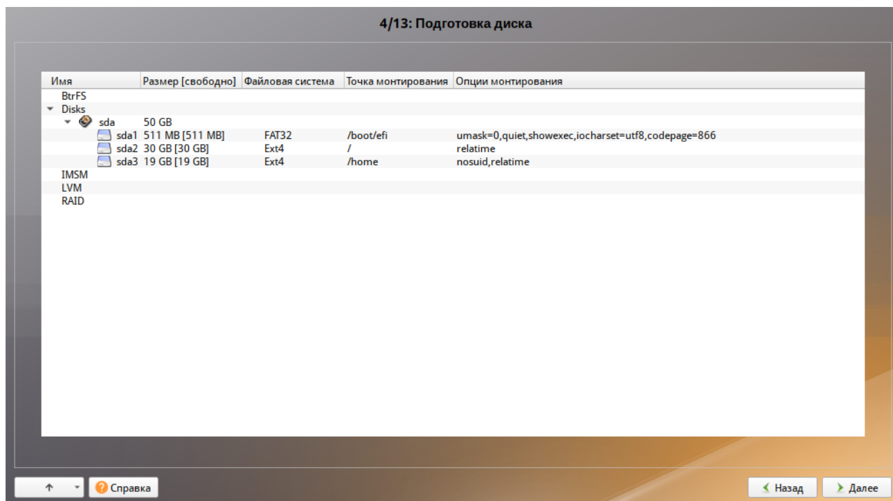
Рис. 14 – Установка. Профиль «Установка рабочей станции»
