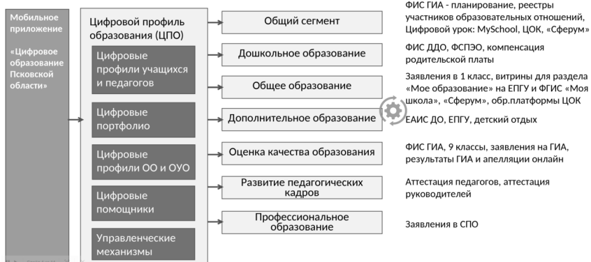
Рис. 1: Интеграция подсистем РИС «ЦОПО»
