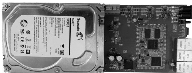
Рис. 1: Одноплатный компьютер с подключённым HDD 3.5 дюйма
